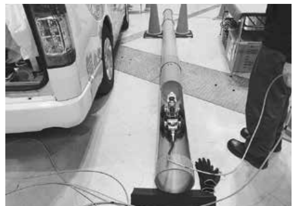
自走式カメラは車内で遠隔操作が可能
